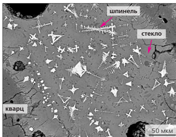
Рис.6. Кристаллизация скелетных кристаллов шпинели в пемзе витрифицированного форта Пассо Альто. В крайней части фото слева видна кристаллизация частично оплавленного при витрификации кварца. Кристаллизация шпинели в виде скелетных кристаллов — следствие очень быстрого охлаждения расплава. Фото в обратно рассеянных электронах.
