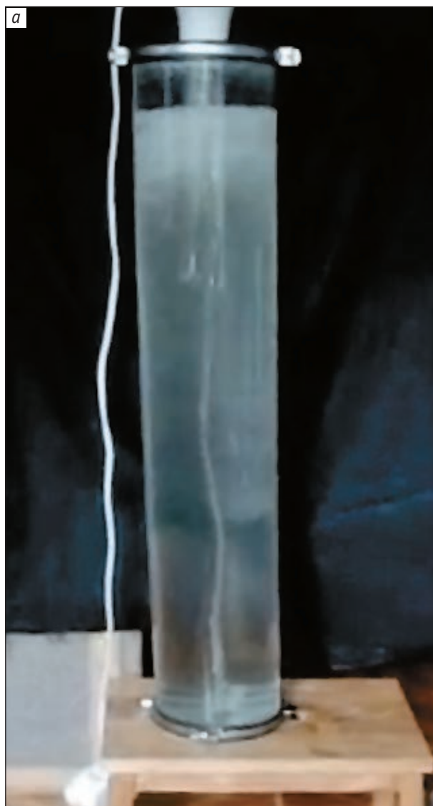
Рис.2. Кадры видеосъемок подводного торнадо: при постоянном возбуждении вращения миксером (а); при возбуждении раскачиванием в начале процесса (б); незадолго до распада торнадо на поток пузырьков (в).
